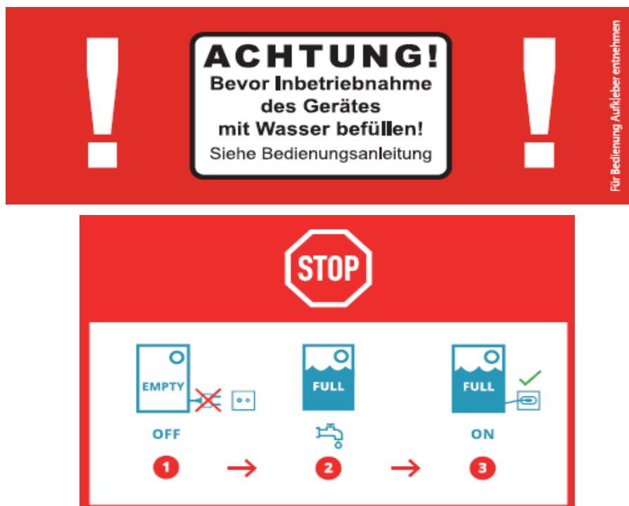
2. Stellen Sie den Wasseranschluss her und prüfen die Dichtigkeit. Nach dem Befüllen und vollständigen Entlüften des Gerätes können Sie den Elektroanschluss vornehmen.
