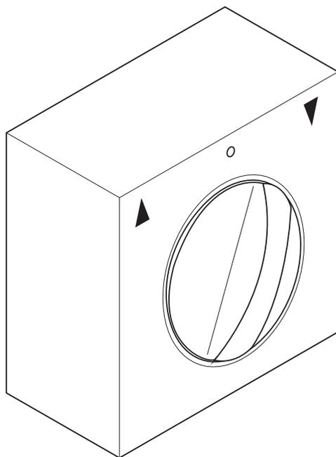
Bei der Schalterstellung ▼ muss die Markise ausfahren, andernfalls muss das Kabel für die ▲ und ▼-Richtung im Steuerelement getauscht werden.
