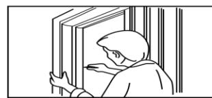
Gleitschiene aus der Türöffnung und führen Sie das Lamellenpaket in die Schiene. Die Gleitschiene zurück schwenken und festschrauben. Die Endlamelle nun an den Türstock schrauben.
