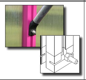
Tisch an den Gewächshaussprossen verschrauben. Hierzu die Streben (Pos. 3) an den Sprossen anschrauben. Dafür werden im Bereich des Kunststoffgleiters je zwei Schrauben M6 x 16 (S5) eingezogen.
