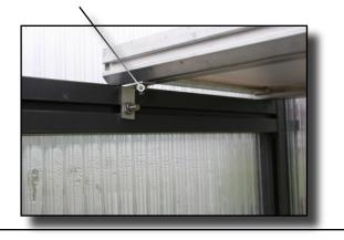
Den Tisch auf dem Querriegel auflegen. Mit dem Auflagewinkel (V185) und der Hammerkopfschraube M6 x 16 (S15) am Querriegel befestigen.
