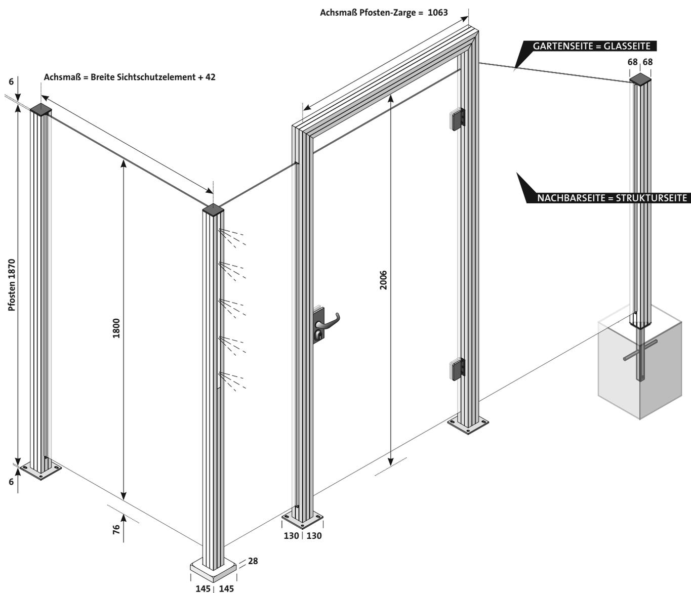
**1** Pfostenanker fachgerecht betonieren bzw. anschrauben
