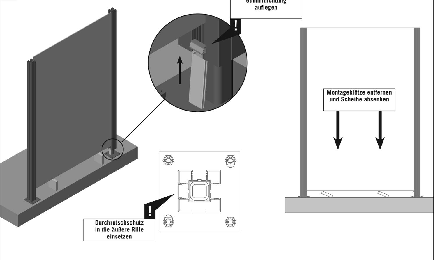
**8** Gummidichtungen montieren
