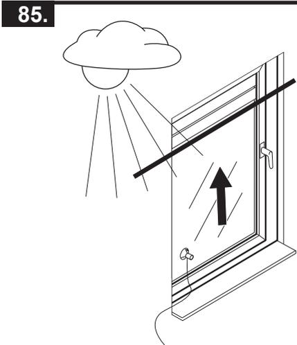
Wird die eingestellte Helligkeit ca. 10 Minuten ununterbrochen erkannt, fährt der Rollladen bis zum Saugknopf des Sonnensensors nach unten. Nach ca. 20 Minuten wird der Rollladen ein Stück hochgezogen, der Sonnensensor ist freigegeben und misst erneut.
