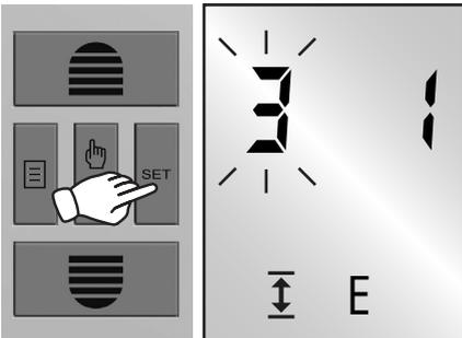
Bei aktivierter Lüftungsfunktion fährt der Rollladen, im Tages- oder Wochenprogramm in die programmierte Lüftungsposition. Eine Fahrt in die Endlage ist nur manuell möglich.
