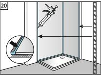
Bitte achten Sie insbesondere auf eine vollständig geschlossene und dichte Ausbildung der Anschlussfugen (21).
