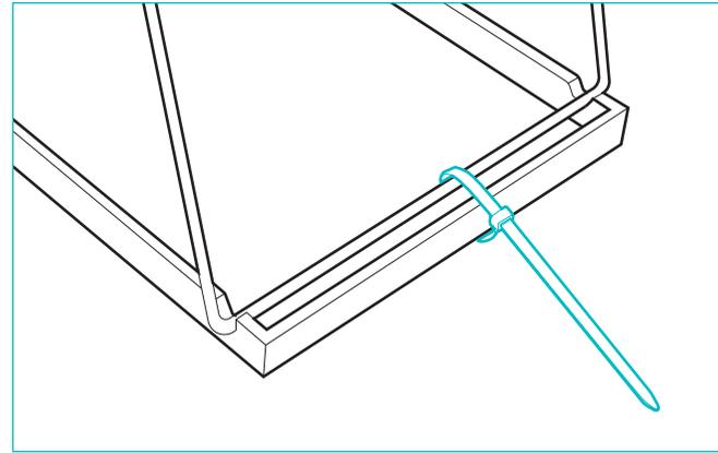
Um die Handhabung der Solarmodule zu erleichtern, werden die Metallhalterungen zunächst mit den mitgelieferten Kunststoffschellen fixiert.
