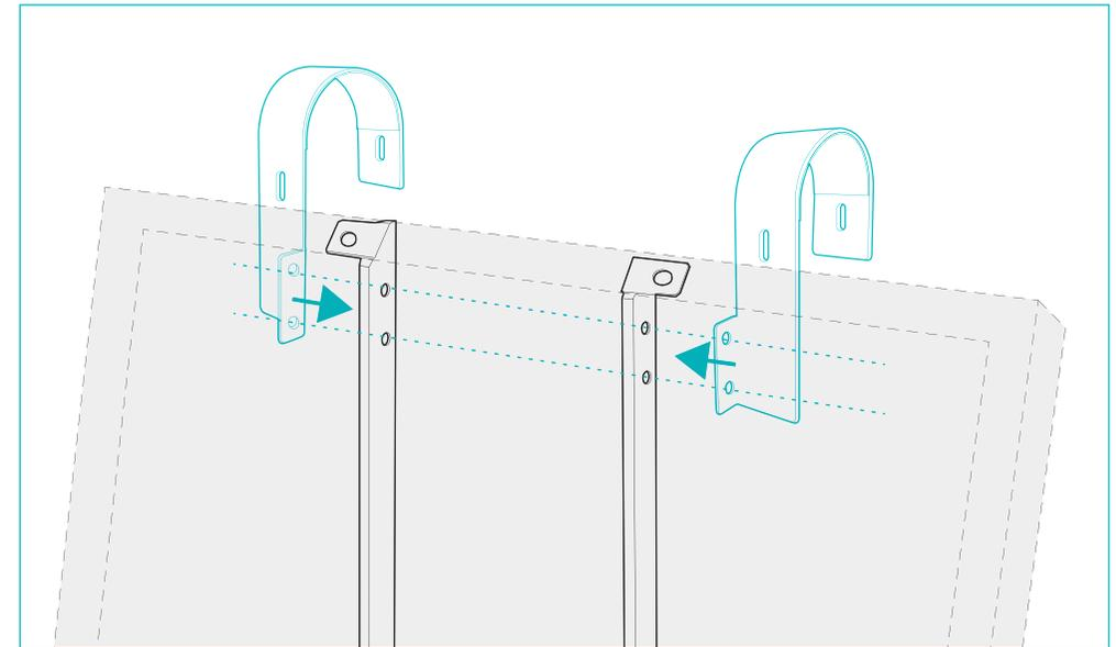
**Achtung:** Es gibt 4 Paar Haken. Achten Sie darauf, sie in der richtigen Richtung zu montieren, einen an der rechten und einen an der linken Seite der Solarmodulhalterung.
