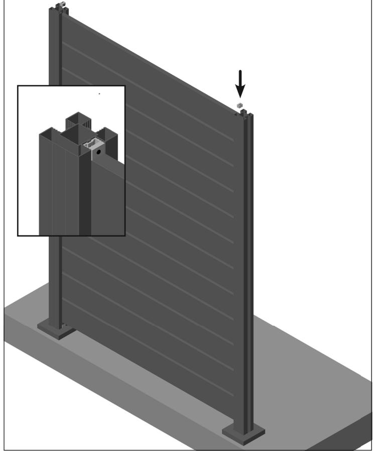
**10** Optional: Durch Lücke der oberen Schraubstege je eine Edelstahl-Schraube als Sicherung in obere Paneele schrauben
