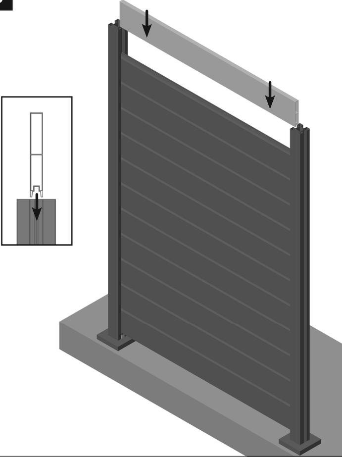
**9** Nachdem alle Paneele sowie optionales Glas eingeschoben wurden, obere Schraubstege montieren
