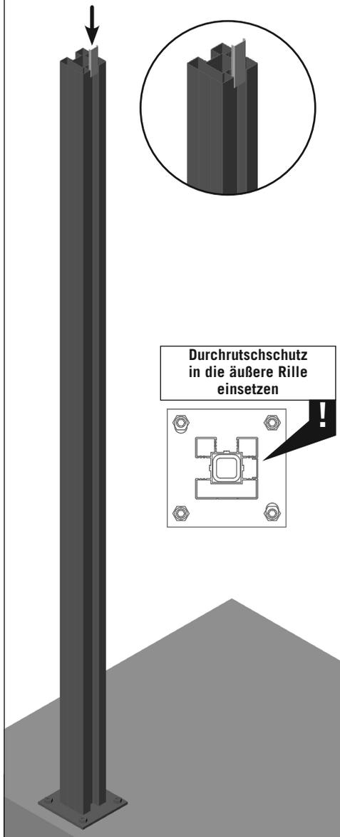
**4** Untere Schraubstege einschieben, justieren und festschrauben
