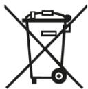
Das auf den Elektro- und Elektronikgeräten regelmäßig abgebildete Symbol einer durchgestrichenen Mülltonne weist darauf hin, dass das jeweilige Gerät am Ende seiner Lebensdauer getrennt vom unsortierten Siedlungsabfall zu erfassen ist. Ein Balken unter der Mülltonne bedeutet, dass das Produkt nach dem 13. August 2005 in Verkehr gebracht wurde.
