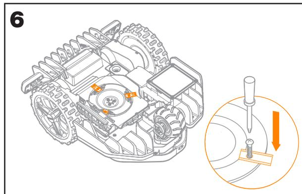
**⚠Achtung:** Wenn Sie neue Klingen anbringen, gehen Sie sicher, dass Sie **ALLE** Klingen austauschen. Verwenden Sie die mit den Klingen gelieferten Schrauben, um einen sicheren Halt zu gewährleisten. Dies ist wichtig, um die Klingen zu sichern und den Klingenteller auszugleichen. Wenn Sie keine neuen Schrauben verwenden, kann dies zu schwerwiegenden Verletzungen führen.
