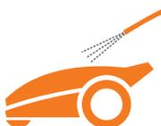
Ihr Landroid Vision sollte regelmäßig gereinigt werden. Dies hilft dabei, den Landroid Vision einsatzbereit zu halten, vor allem bei Entfernung von Schmutz, Verunreinigungen und Grasansammlung durch tägliches Mähen. Schalten Sie den Landroid Vision aus, bevor Sie das Gerät reinigen. Entfernen Sie zur zusätzlichen Sicherheit den Akku.
