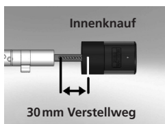
Schematische Darstellung Innenknopf-Verstellung
