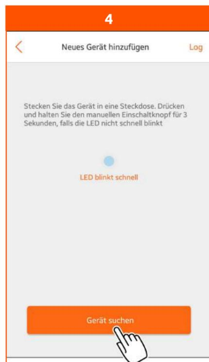
Schalten Sie die Leuchte an der Haussicherung ein. Die Leuchte schaltet sich ein. Die Kontrollleuchte der Leuchte blinkt schnell. Wenn die Leuchte wieder erloschen ist, drücken Sie auf „Gerät suchen“. Die App sucht die Leuchte. Wenn die Kontrollleuchte nicht schnell blinkt: Drücken Sie an der Leuchte den Funktionstaster min. 3 Sekunden und max. 6 Sekunden lang.
