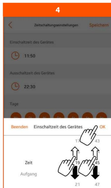
Um die Einschaltzeit einzustellen: Wählen Sie die Stunde (linke Spalte) und die Minute (rechte Spalte). Oder: Wählen Sie „Untergang“ für das Einschalten bei Sonnenuntergang. Drücken Sie „OK“. Die Einschaltzeit ist eingestellt. Stellen Sie die Ausschaltzeit genauso ein. Für das Ausschalten bei Sonnenaufgang wählen Sie „Aufgang“.
