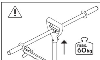
Den Plattenhebergriff in die Vorrichtung des montierten Tragarm einhängen.
