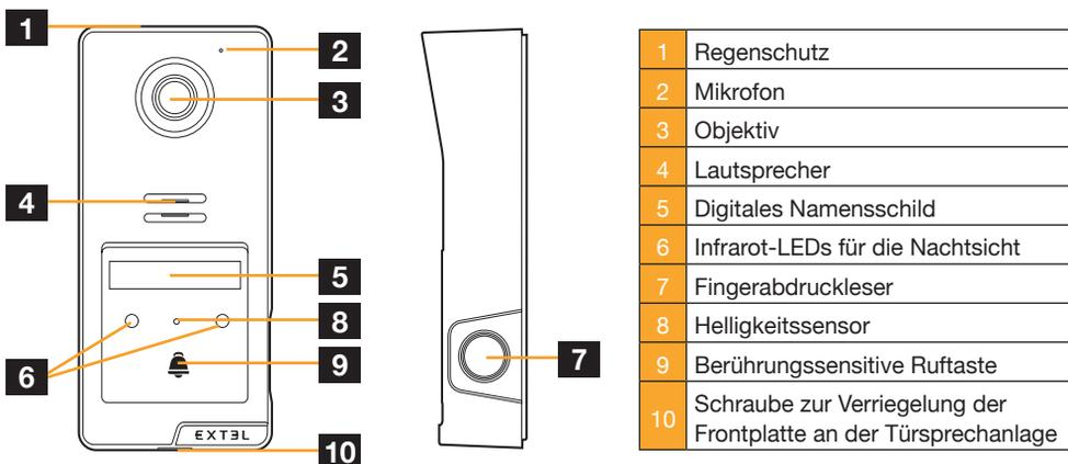
**Wichtig:** Die Verriegelungsschraube darf nicht entfernt werden. Um die Frontplatte der Türsprechanlage abzunehmen, lösen Sie die Schraube mit dem dafür vorgesehenen Werkzeug. Beim Lösen der Schraube versinkt diese anstatt herauszukommen: Das ist normal. Üben Sie keinen Druck auf die eingedrehte Schraube aus: Sie kann dadurch beschädigt werden.
