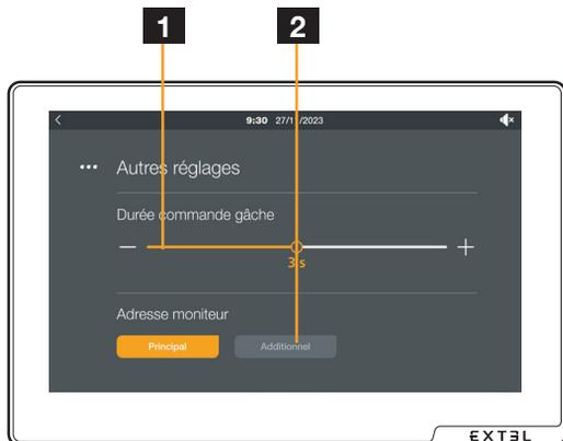
1 Einstellung der Betätigungszeit des elektrischen Türöffnerausgangs im Bereich von 1 bis 5 s.
