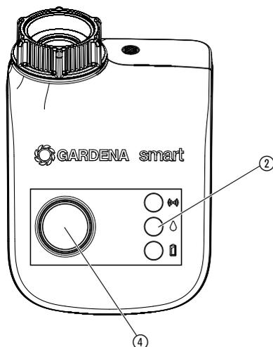
Das Ventil kann jederzeit manuell geöffnet oder geschlossen werden (nur während des Einbindungs-Modus ist keine manuelle Bewässerung möglich). Auch ein programmgesteuertes offenes Ventil kann vorzeitig geschlossen werden, ohne die Programmdaten zu verändern.
