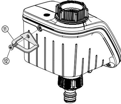
1. Schelle ⑪ mit der Schraube ⑫ an der Rückseite des Water Control festschrauben.
