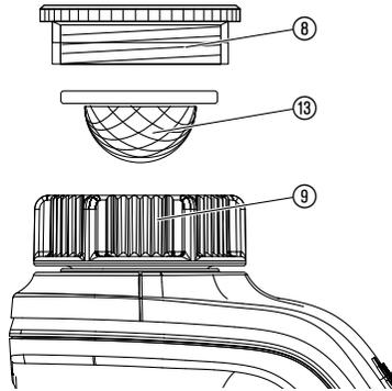
Das Schmutzsieb ⑬ sollte regelmäßig kontrolliert werden und bei Bedarf gereinigt werden.
