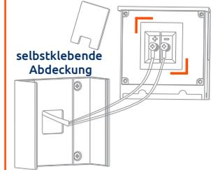
Montieren Sie die Türsprechanlage mindestens 1,3m über dem Boden für den optimalen Betrieb (beste Höhe ist etwa 1,6m über dem Boden). Siehe auch Bild Seite 10.
