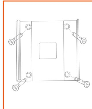
*Hinweis: Bevor Sie die Halterung an die Wand schrauben, prüfen Sie, ob die Türsprechanlage an dieser Stelle funktioniert. Wenn nicht, müssen Sie Ihr WLAN erweitern oder einen anderen Standort wählen.*
