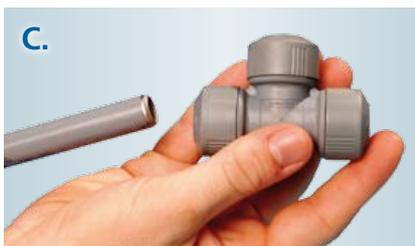
Bevor Sie die Steckverbindung ausführen, prüfen Sie den festen Sitz der Überwurfmutter – ziehen Sie diese handfest ohne Werkzeug an. Dann Rohr und einbaufertigen Fitting **bis zum Endanschlag** ineinanderschieben. Dazu müssen **zwei Druckpunkte** (Haltekralle und O-Ring) überwunden werden. **Volle Einstecktiefe ist sichergestellt**, wenn die V-Markierung die Muffe des Fittings erreicht hat, mit etwas Montagefett Nr. 39 ist die Verbindung noch leichter herzustellen.
