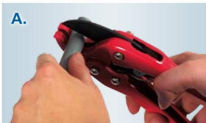
StecMa-Rohre nur mit einer Kunststoff-Rohrschere schneiden. Keine Bügelsäge verwenden! Einstecktiefe des Rohres markieren, am besten aufgebrachte V-Markierungen benutzen.
