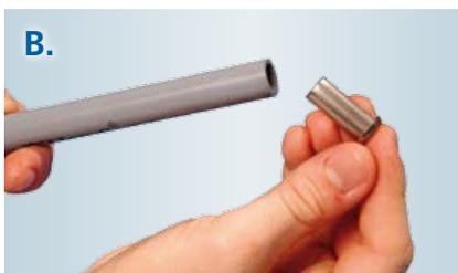
Eventuell vorhandenen Grat entfernen und die Edelstahl-Stützhülse in das Rohrende einführen.
