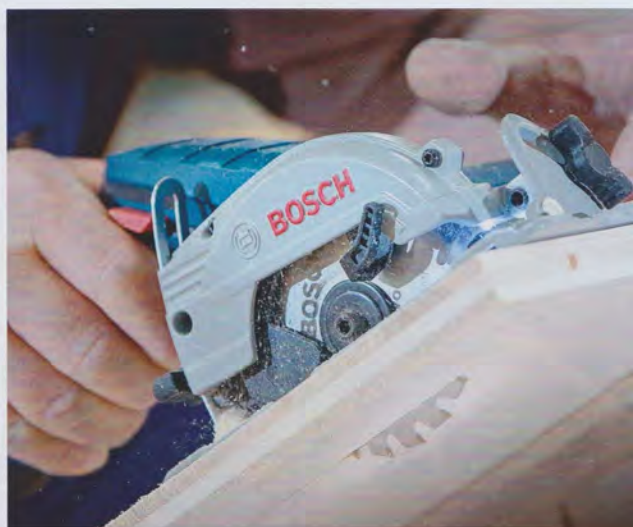
Die „GKS 10,8 V-LI Professional“ schneidet Holz und Holzwerkstoffe bis zu einer Schnitttiefe von 26,5 Millimetern.
