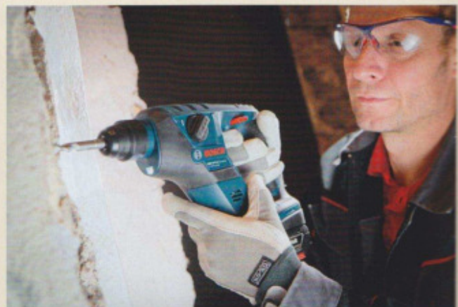
Der maximale Bohrdurchmesser in Holz beträgt 16 mm, mit Hammerbohrern sind mit dem „GBH 18 V-LI Compact Professional“ in Beton Bohrdurchmesser von 12 mm möglich.
