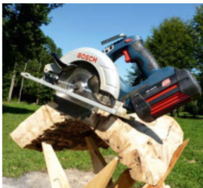
Lange Leistung: Die Handkreissäge „GKS 36 V-LI Professional“ soll mit einer 2,6-Ah-Akkuladung bis zu 85 m in Spanplatte laufen – nachweislich zerteilte sie das ringschälige Eichenstück von über 50 mm Dicke.
