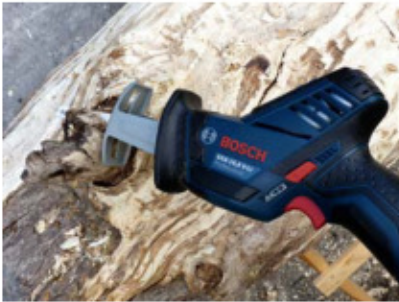
Empfohlene Schnitttiefe: 65 mm in Massivholz bewältigt die kompakte Sägeblattsäge „GSA 10,8V-LI Professional“ spielend, wie hier beim Entfernen eines Astes.
